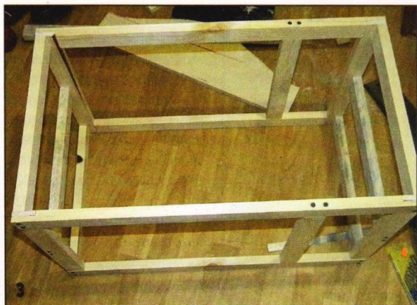
Рамы усилил поперечинами.
