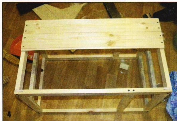
Обшивать каркас вагонкой начал с днища.
