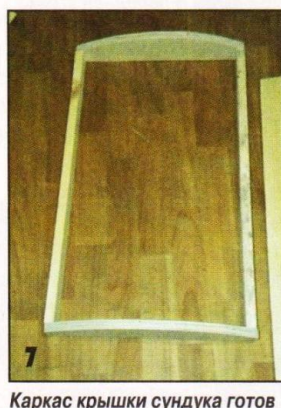
Каркас крышки сундука готов под обшивку.
