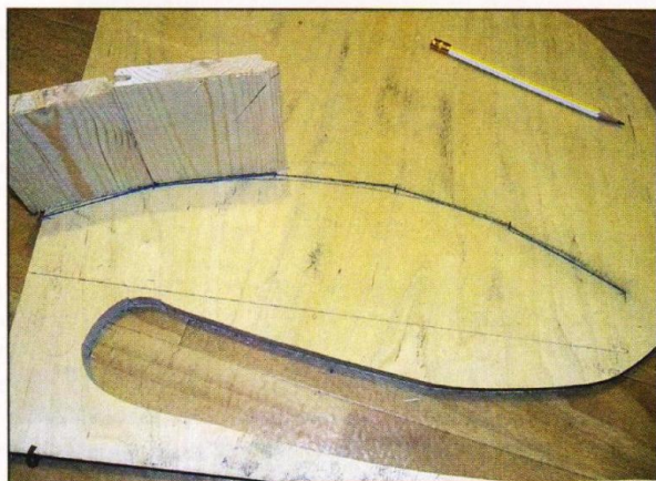
Боковины для крышки сундука выкроил из толстой фанеры.
