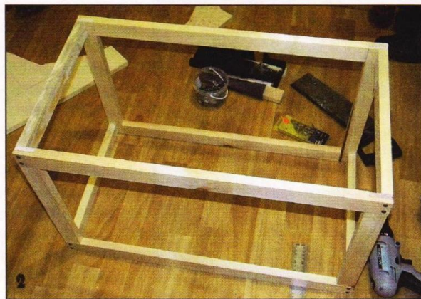
2 Каркас сундука без крышки.
